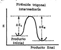
$\Delta E_1$  = energía absorbida inicialmente por la molécula para efectuar la unión  $P^{-18}O$  apical, con la formación de la bipirámide trigonal intermediaria.
