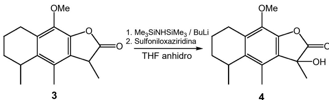
En un matraz bola provisto con un agitador magnético, un tapón tipo septum con una aguja de salida, se mantuvo un flujo de nitrógeno para lograr una atmósfera inerte y bajo un baño de hielo seco, se inyectaron 0.4 mL ( $1.92 \times 10^{-3}$  mol) de hexametildisilazano y 0.59 mL ( $1.81 \times 10^{-3}$  mol) de butilitio [2.5 M] en 0.6 mL de THF seco como disolvente, guardando las precauciones convenientes en el manejo de estos reactivos.
